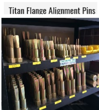
ตัวอย่างอุปกรณ์ที่ใช้ช่วยในการใส่(line up Pin) และถอด (Spreader) Flange
